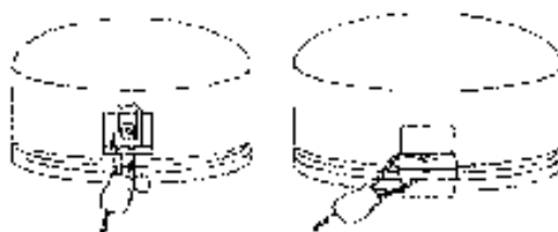
Рис. 25. Схема установки специализированного ЗПУ с длиной каната 300 мм на колпаке сливо-наливной арматуры специализированной цистерны
